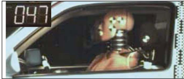
Abb. 17 Zeitpunkt des Aufreissens des Lenkraddeckels.
