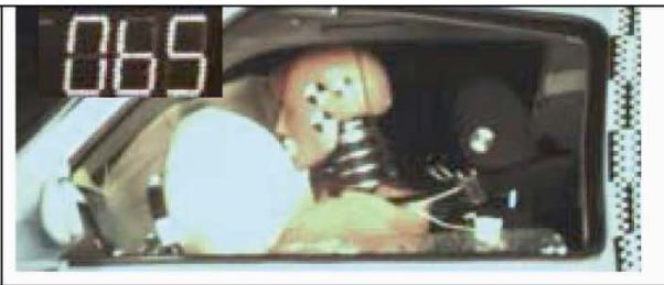
Abb. 18 Zeitpunkt der Berührung von Kinn auf Airbag.
