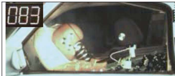
Abb. 19 Zeitpunkt der 3 ms-Spitzenbeschleunigung.
