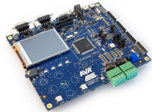
Atmel AT32UC3C-EK (Quelle: Atmel)
