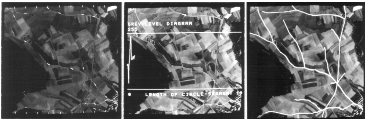
Abb. 4.15: Beispiel für ein sequentielles Linienextraktionsverfahren.
