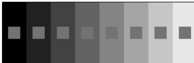
Abb. 2.1: Beispiel dafür, dass das Auge kein objektives Messgerät ist: es sieht ein und denselben Grauwertfleck in Abhängigkeit von seiner Umgebung unterschiedlich hell.
