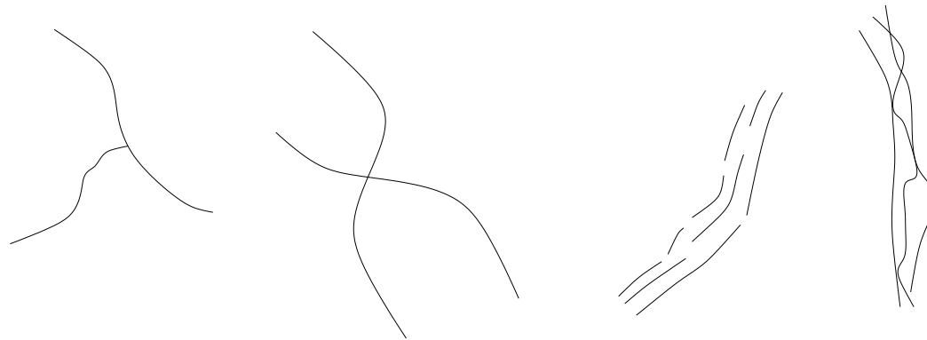
Abbildung 6: Typische Situationen bei der Linienverfolgung: Sich kreuzende, parallele unterbrochene, sich berührende Linien
