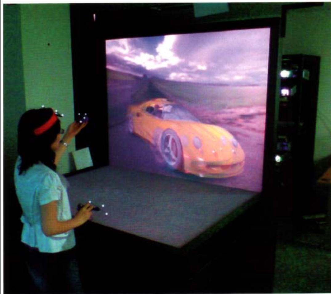
Stereo-Projektion mit Hilfe von Polarisationsfiltern
