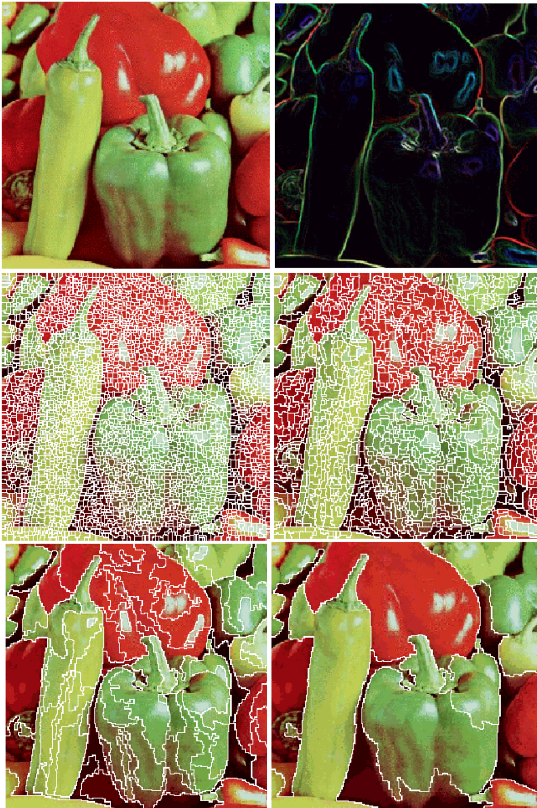
Abb. 2.9: Beispiel für das Flutungs-Verfahrens und die Wasserscheiden-Transformation; Original-Farbbild, Gradientenbild, Übersegmentation, 1., 3. und 5. Iteration; (Quelle: http://iristown.engr.utk.edu/~koschan/paper/FarbW2000.pdf ).
