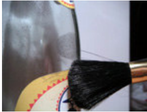
☑ Bild 2: Sichtbarmachen mit Graphitpulver
