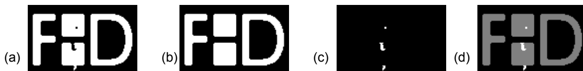
Abb. 14.8: Beispiel für die Bilddifferenz zur Anzeige von Rissen, Löchern und Ausreißern:
