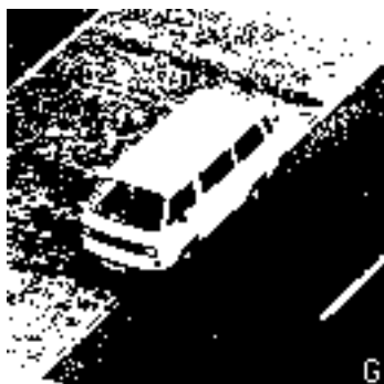
Abb. 6.3: Beispiele für die Reduzierung der Grauwert-Anzahl zu Abbildung 6.1 (j): (a) Äquidensitenbild unter Berücksichtigung des höchstwertigen Bits; (b) Äquidensitenbild unter Berücksichtigung der beiden höchstwertigen Bits.
