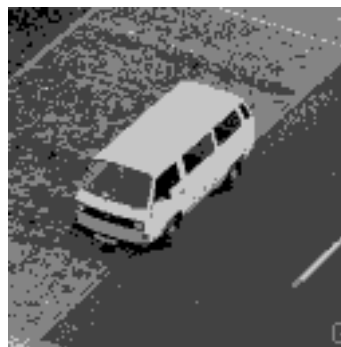
Abb. 6.3: Beispiele für die Reduzierung der Grauwert-Anzahl zu Abbildung 6.1 (j): (a) Äquidensitenbild unter Berücksichtigung des höchstwertigen Bits; (b) Äquidensitenbild unter Berücksichtigung der beiden höchstwertigen Bits.
