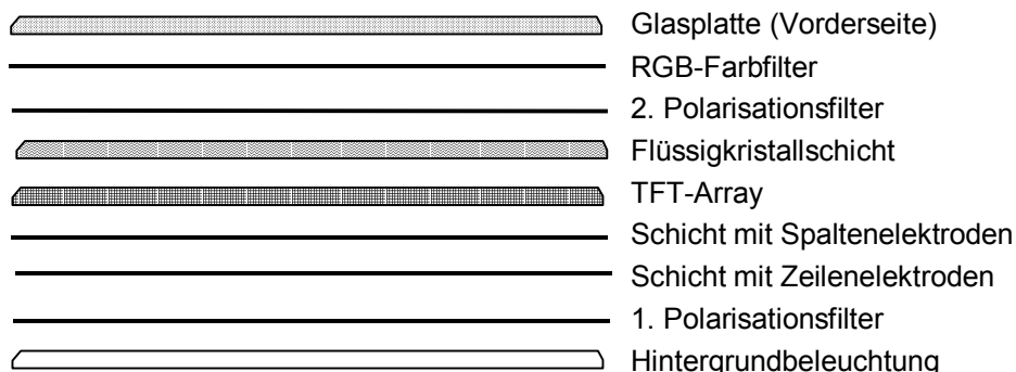
Abb. 5.4: Prinzipieller Aufbau eines TFT-LCDs im Querschnitt
