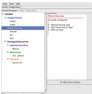
In Red Hats Werkzeug system-config-cluster lassen sich unter anderem die Fencing-Techniken konfigurieren.
